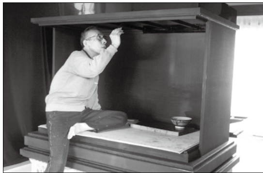
塗りを行う布清信氏 上塗りには地元輪島の漆が使われた
