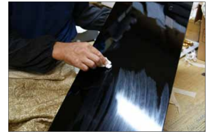
(2) 真綿で漆を伸ばして行く。鏡面のような光沢を得るために前工程の塗り部分（漆仕上げ）は呂色により磨き上げられている。箔押しを鏡面に仕上げるためには箔を押す面の光沢と拭き上げの技術がポイントとなる。
