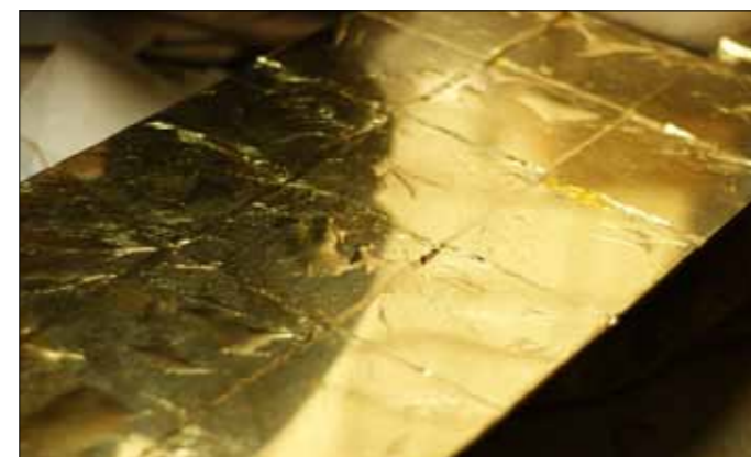
(9) 艶押し箔の仕上がり直前 この段階で鏡面であることが十分に分かる
