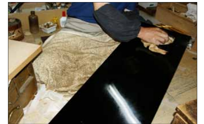
(3) 漆の拭き取りを始める。蛍光灯の映りから、漆が残っていることが分かる。
